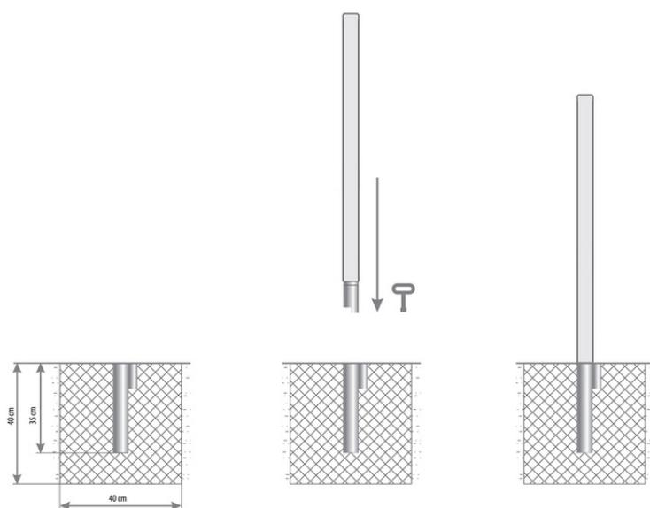
Scavare una buca profonda per il plinto di fondazione. Il plinto deve rispettare le misure:
