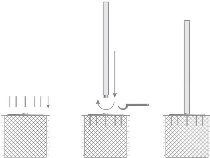
Fissare la piastra alla superficie in cemento tramite 8 tasselli (inclusi).
